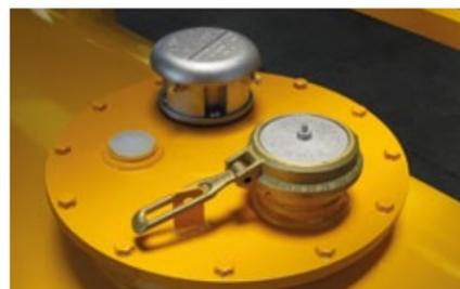
Passo d'uomo Ø 350 con guarnizione a tenuta. Completo di bocca di carico da 3" con tappo a chiusura rapida, valvola di sicurezza a doppio effetto e tappo di fusione.
