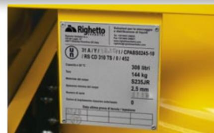
Ogni singolo serbatoio prima di essere venduto viene sottoposto a prova di collaudo dall'ente certificatore. La targa applicata sul serbatoio riporta gli estremi della certificazione.
