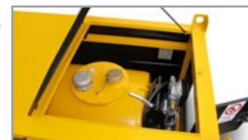
Con bacino di contenimento capacità 110% verniciato, saldato a tenuta, con accesso lucchettabile con botola sul coperchio con porta lucchettabile sul lato del gruppo erogatore.
