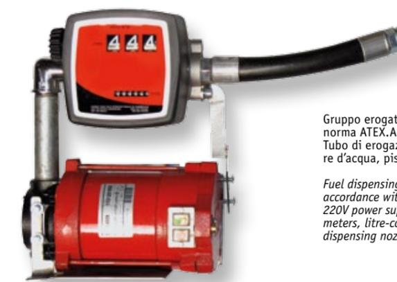
Gruppo erogatore da 50 lt/min per carburanti avio a norma ATEX. Alimentazione a 220 volt, 12 o 24 volt. Tubo di erogazione da 4 m., contalitri, filtro separatore d'acqua, pistola automatica.
