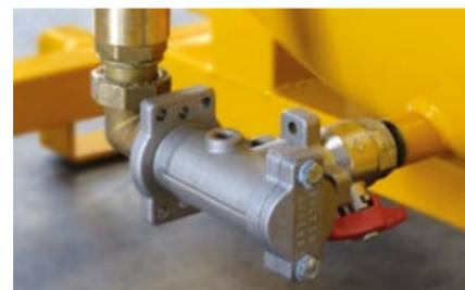
Attacco di aspirazione con valvola di chiusura a sfera, filtro in rete metallica per una facile manutenzione, valvola di non ritorno.
