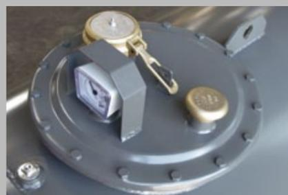
Passo d'uomo  $\varnothing$  420 mm con guarnizione a tenuta. Completo di bocca di carico da 3" con chiusura e attacco rapido lucchettabile in bronzo, valvola limitatrice di carico al 90% della capacità omologata. Indicatore di livello meccanico con struttura di protezione. Fungo di sfiato con reticella rompifiamma.
